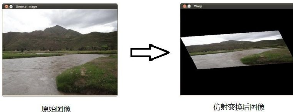
图 25 opencv 官网上对 warpAffine 使用的示例
